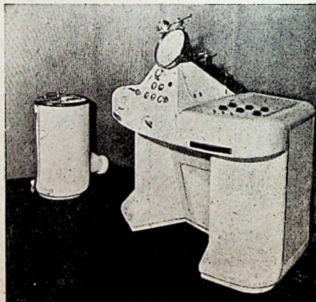
Fig. 4. — Electronenmicroscopie van 100 kV met continu regelbare vergroting van 1000 maal tot 150.000 maal. De scherpstelling van het beeld is door een speciale methode zeer gemakkelijk. Men kan met enkele handgrepen in plaats van de vergrote afbeelding van het object een electronen-diffractiediagram van het te voren afgebeelde gedeelte op het scherm krijgen. — Op de foto ziet men de microscopietubus schuin naar boven gericht boven op het toestel. Opvallend is het grote scherm, waarop het beeld zichtbaar wordt. Details van het beeld kunnen met een loupe worden bekeken. Het beeld kan — op 4 maal gereduceerde schaal — fotografisch worden vastgelegd op 35 mm-film met behulp van een in de tubus gebouwde camera. De hoogspanning, die door een speciale schakeling is gestabiliseerd, wordt geleverd door de links op de foto zichtbare, in een afzonderlijke buis ondergebrachte generator, die door een flexibele kabel met het electronenmicroscopie is verbonden.
